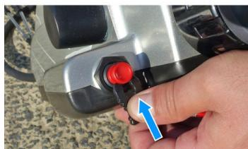
11. 非常停止スイッチに非常停止スイッチクリップを取付けます。
