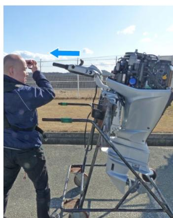
13. 始動ロープを静かに引いて、重くなったところで周囲に十分注意して強く引っ張り、エンジンを始動させます。
