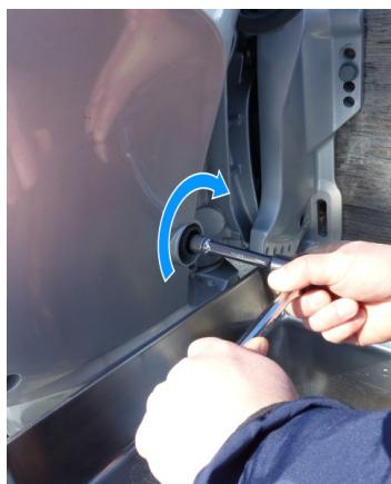
11. エンジンオイルを排出したら、ドレンボルトを新品のシーリングワッシャーとともに取り付けてください。工具でしっかりと締めつけます。
