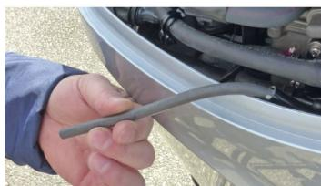
3. インテークマニホールドの突起部に固定されているドレンチューブを外し、チューブの端をアンダーカバーの外に出します。
