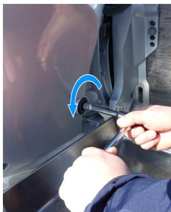
10. ドレンボルトカバーの下にドレンパン（排油受け）を置きます。ドレンボルトを工具を使って取り外します。エンジンオイルがしづくになるまでしっかりと排出してください。
