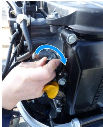
18. 点火プラグを、ネジ山を壊さないように、まず指で軽くまでねじ込みます。手でいっぱいに締めこんでから、工具で $1/8$ — $1/4$ 回転締めつけます。
