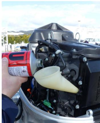
12. オイルレベルゲージの上限まで新しい推奨エンジンオイルを補給します。補給の際は上限を超えないようにしてください。多すぎるエンジンオイルはエンジンに悪影響を与えます。
